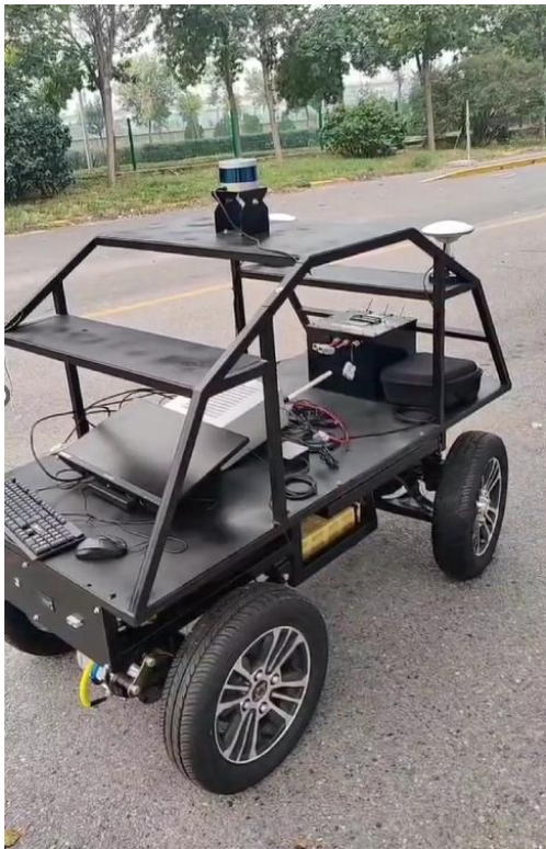
没有方向盘输入轴，专为无人驾驶设计
