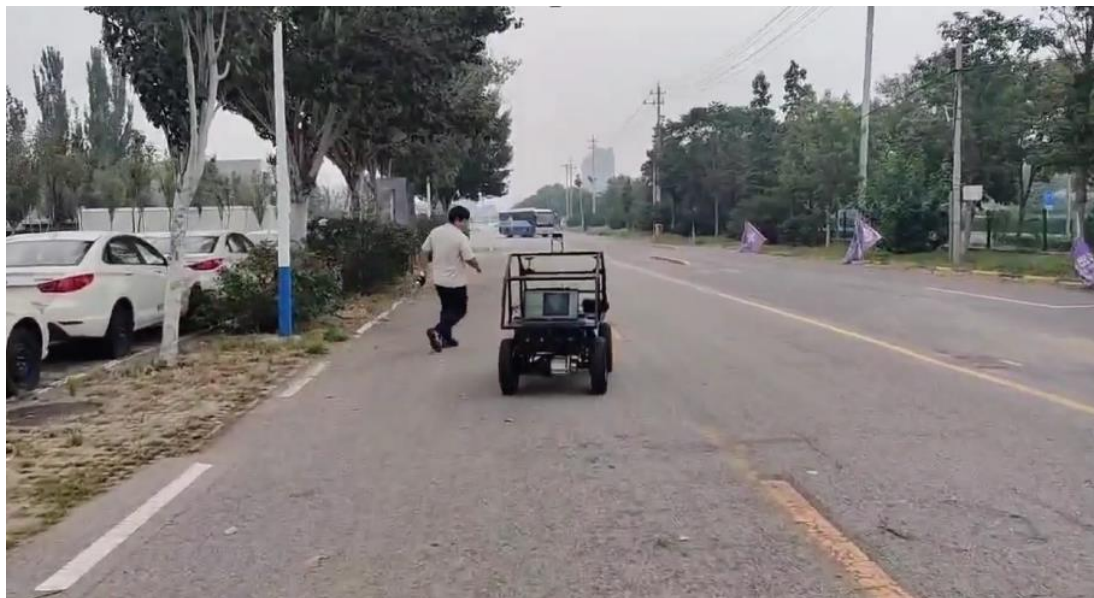
低速车无人车，最高车速不超过25km/h的纯电动非道路无人驾驶专用车。例如，用于配送、运输、零售、巡逻、清扫等特定场景的专用作业车辆。
